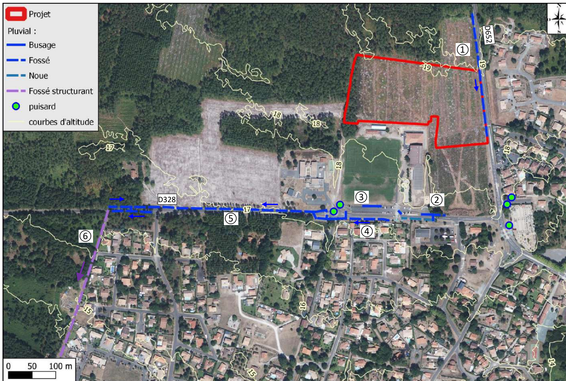
Figure 7 – Réseau hydraulique superficiel – échelle : 1/5 000
