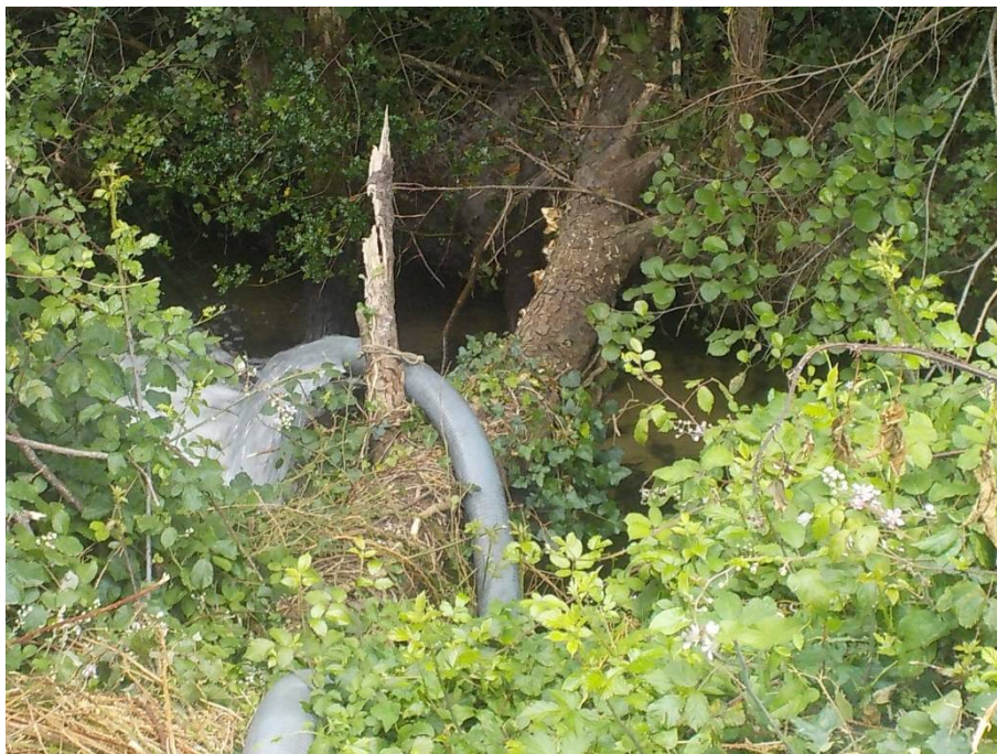
Rejet du pompage longue durée (81 m 3 /h)
