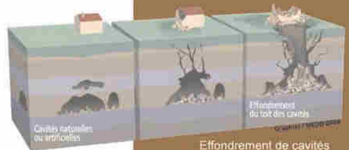
Effondrement de cavités souterraines
