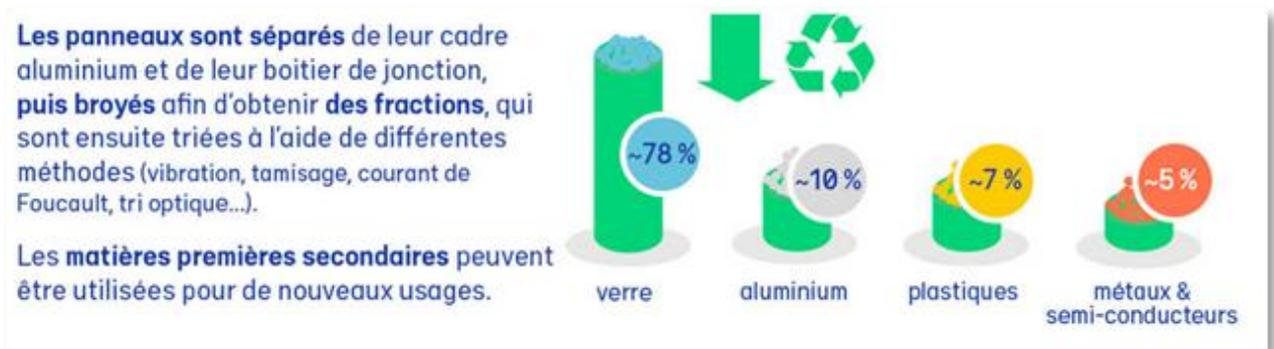
Figure 4 : Procédure de recyclage des panneaux (source : SOREN)
