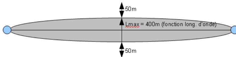
En pratique, on assimile le faisceau à une bande et l'assiette ne dépassera pas 50m de part et d'autre de l'axe :
