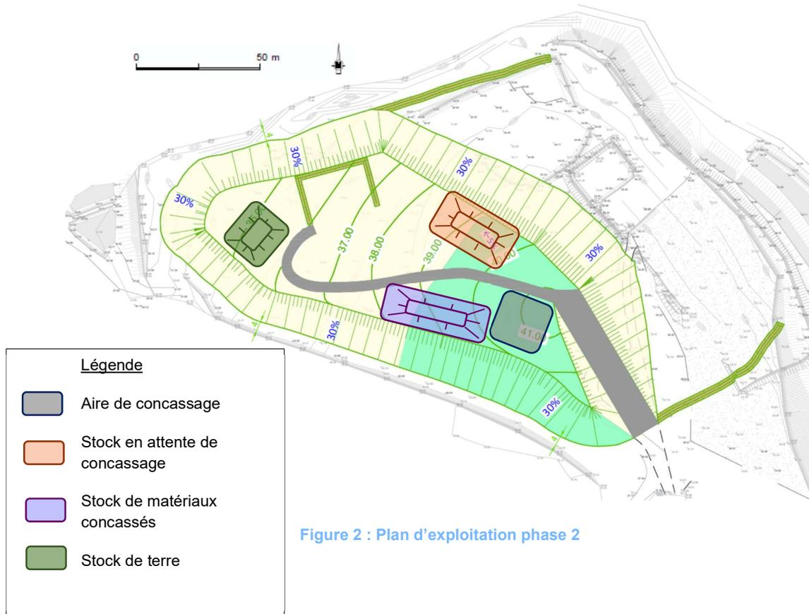
Figure 2 : Plan d'exploitation phase 2
