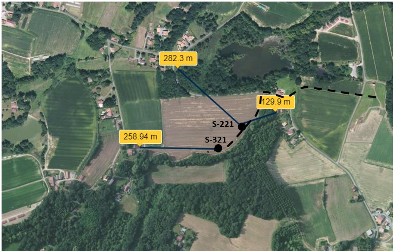
Figure 1 : Présentation des distances entre les puits et les habitations et du tracé des canalisations (d'après document ANTEA)
