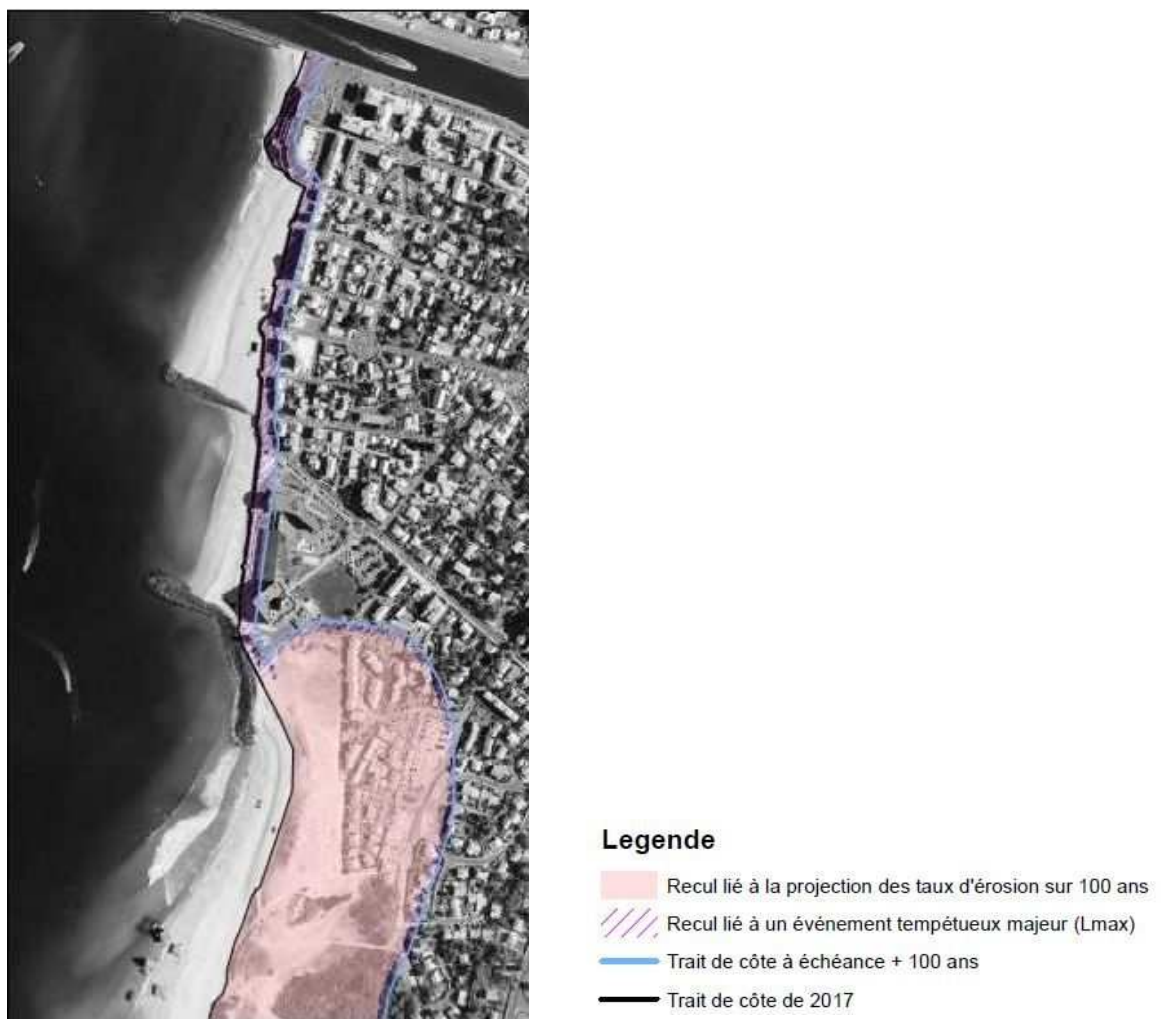
Figure n°2 : aléa recul du trait de côte – focus sur le front de mer de Capbreton
