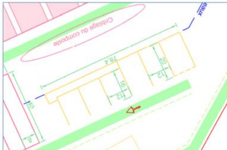
Visualisation du bâtiment séchage en 2D faisant apparaître les 3 cellules de séchage
