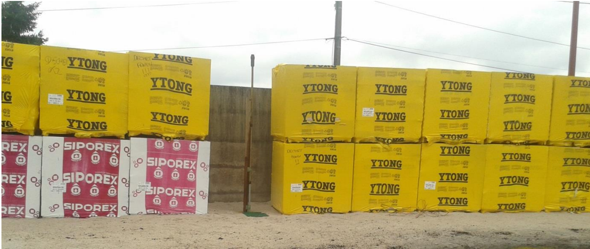
Figure 30 : Mur de ceinture et blocs en Siporex
