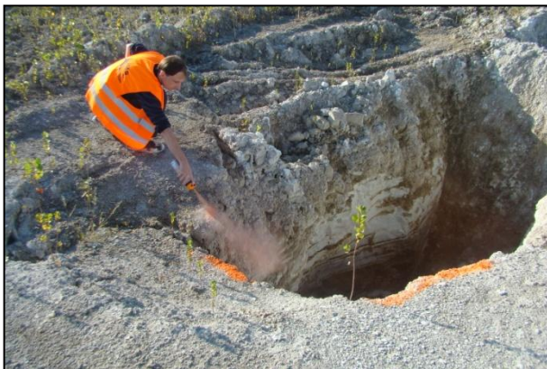
Figure 64 : Mise en place de témoin à la peinture au niveau des limites de fontis et des fissures périphériques [Source : IMS RM ]
