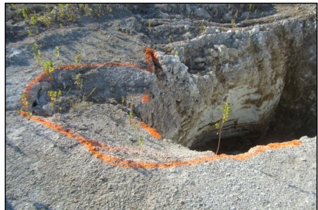
Figure 64 : Mise en place de témoin à la peinture au niveau des limites de fontis et des fissures périphériques [Source : IMS RM ]
