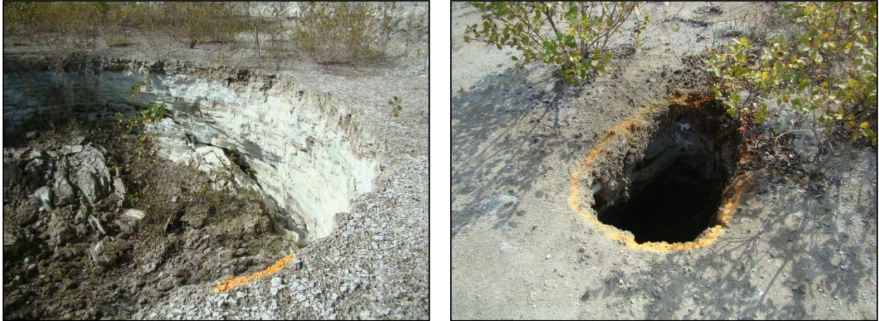
Figure 75 : Absence d'évolution au niveau des témoins tracés les 11 et 12/09/2014 [Source : IMS RN ]
