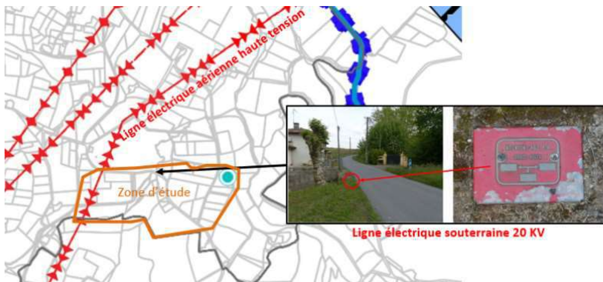
Figure 36. Réseaux électriques dans le secteur d'étude (Sources : extrait PLUi-H du Grand Dax pour la ligne 63 KV / repérage terrain Antea Group pour la ligne 20 KV et photos)
