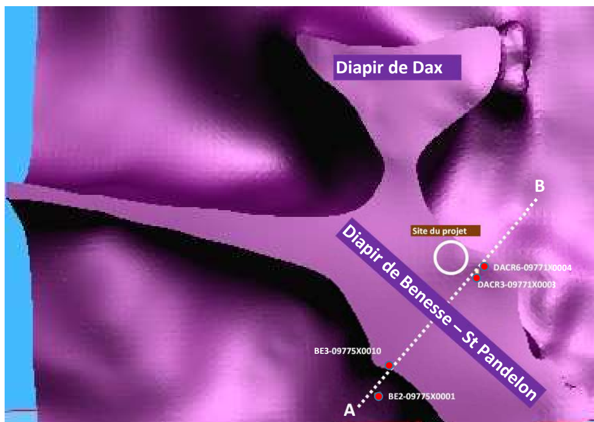
Figure 7 : coupe horizontale du Trias extraite du modèle géologique 3D passant par les sondages DACR3 et 6, BE2 et 3 (Wicquart et al., 2013)
