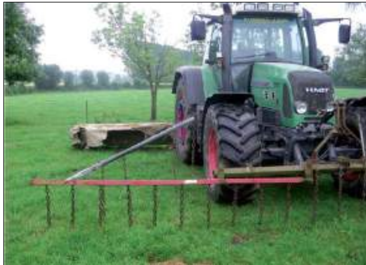
Barre d’effarouchement implantée sur un engin mécanique
