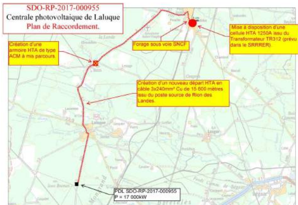
Figure 45 : Tracé prévu pour le raccordement de la centrale photovoltaïque de Laluque (source : ENEDIS)
