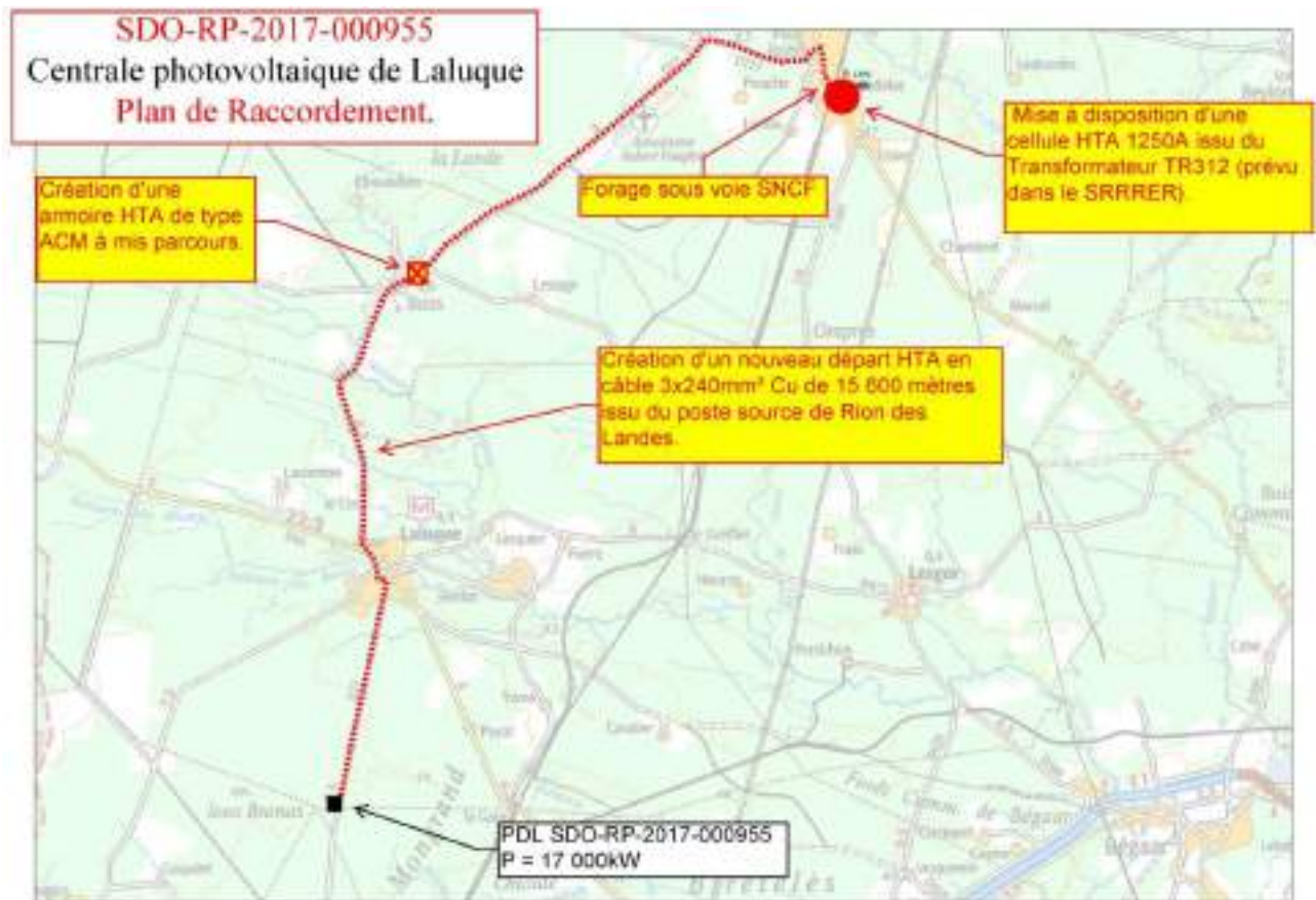
Figure 10 : Tracé prévisionnel du raccordement électrique de la centrale photovoltaïque de Laluque (Source : ENEDIS)
